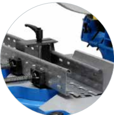
THINFIX-SPANNSYSTEM Für offene Profile. Optinal (Art.-Nr. 600546)
